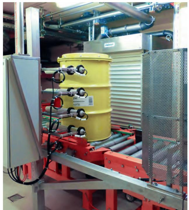
Fassmessanlage für neue Endlagergebäude in der Plasma-Anlage
