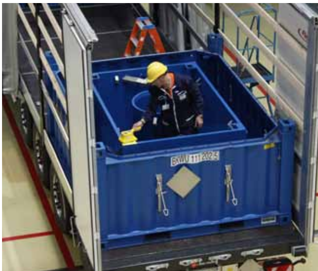
Strahlenschutzmessungen an einem 10-Fuss-Transportcontainer
