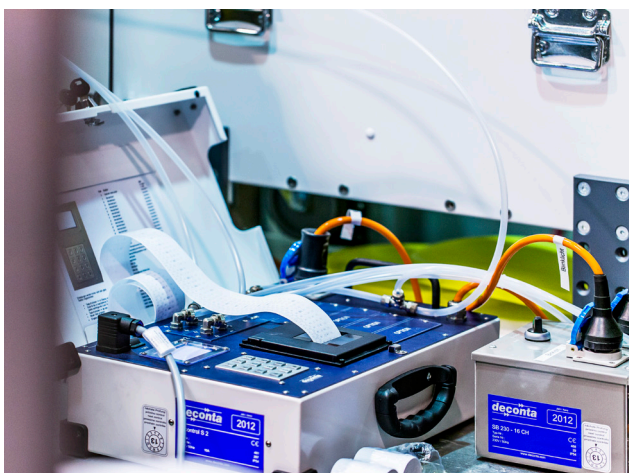
Einrichtung zur kontinuierlichen Messung der Raumluft
