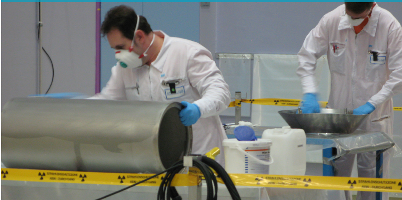
Dekontamination von Hilfseinrichtungen bei der wiederkehrenden Prüfung von Behältern
