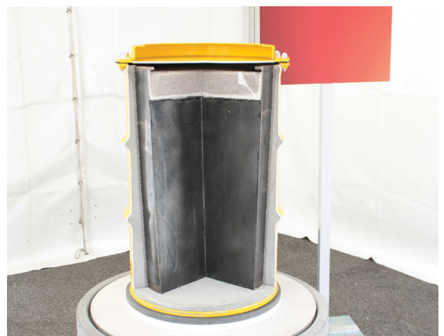
Konditioniertes Gebinde aus Plasma-Anlage
