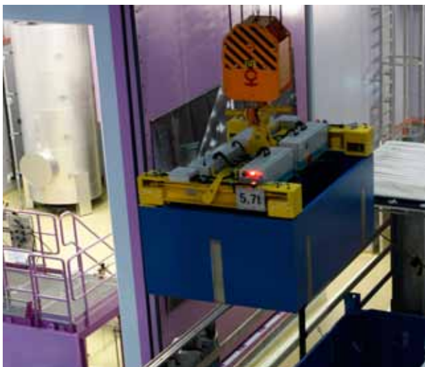
Container für den Transport von mittelaktiven 200 Liter Fässern
