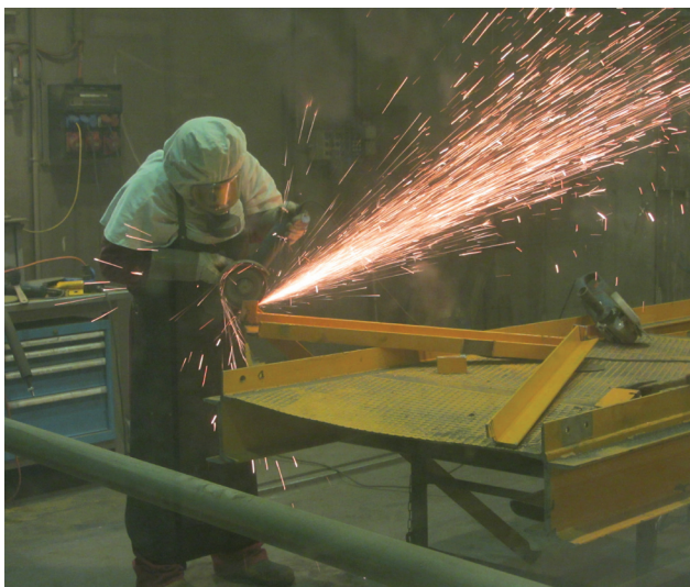
Zerlegung und Dekontamination von Metallteilen
