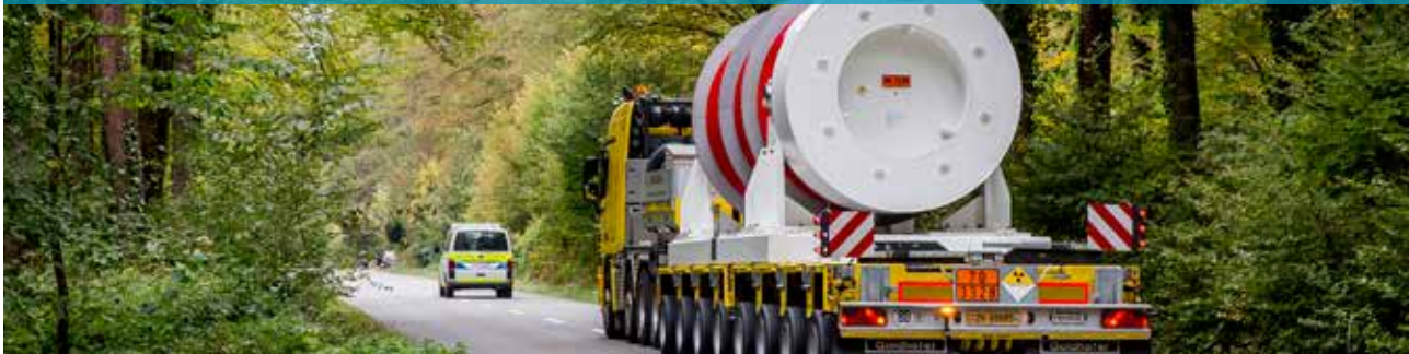
Behältertransport von der Umladestation zum Zentralen Zwischenlager
