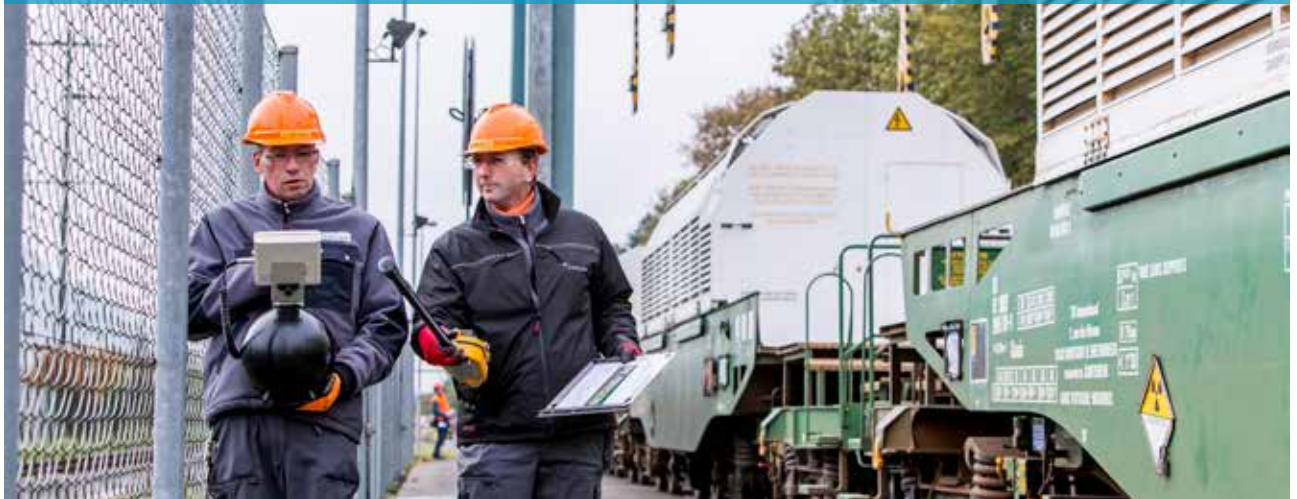
Messung der Ortsdosisleistung an der Arealgrenze der Umladestation
